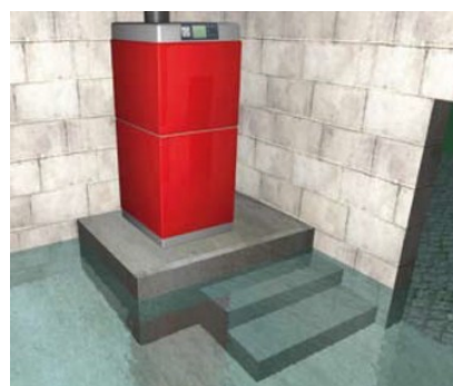
Mise hors d'eau par surélévation
