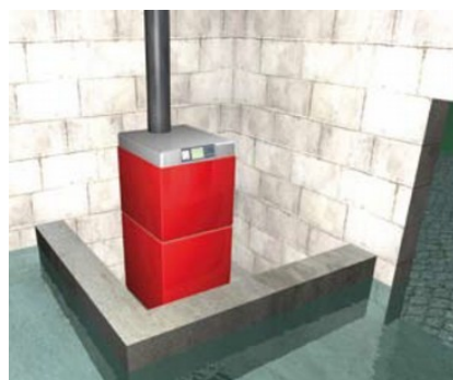
protection par disposition étanche
